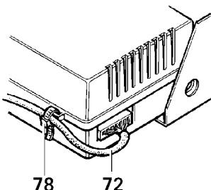
Als trekontlasting van de kabel van het bedienelement (72) door middel van de ingesloten kabelbinder (78) aan de regelelektronica beveiligen.
