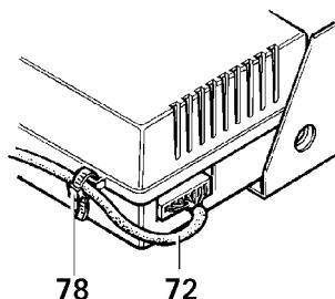
A modo de sujetacables, fije el cable de elemento de mando (72) a la electrónica de control, por medio de las bridas adjuntas (78).
