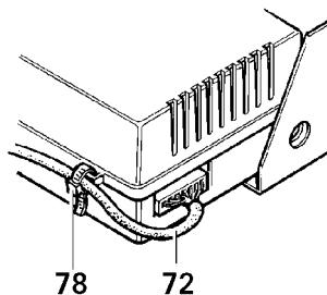
En tant que délestage de traction, attacher le câble de la pièce de commande (72) à l'aide du collier fourni (78) au niveau du système électronique de commande.
