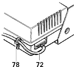
Per eliminare la trazione, fissare il cavo dell'unità di comando (72) al dispositivo elettronico di comando con il fermo fornito (78).
