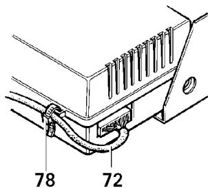
Als Zugentlastung das Bedienteilkabel (72) mittels beiliegendem Kabelbinder (78) an der Steuerelektronik sichern.
