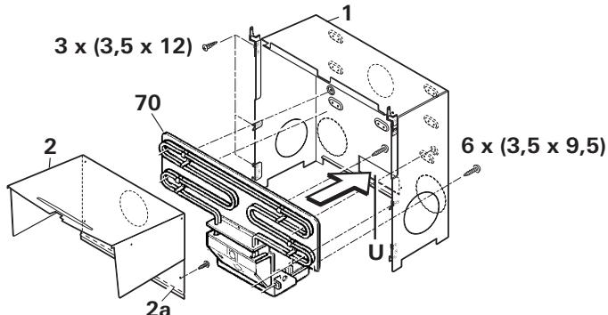
Poursuivez le montage du chauffage conformément aux instructions de montage du chauffage respectif.
