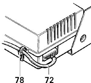
Som trækaflastning skal betjeningsdels kabel (72) sikres på styreelektronikken med den vedlagte kabelbinder (78).
